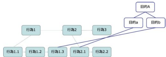
図 3: 作業フローに対して目的指向ツリーを関連づけた例
