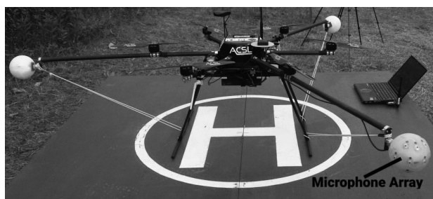
図2 ドローンによる地上の音源探査。 先端に取り付けてある白い球の一つが 16 ch のマイクロホンアレイとなっている ([公文 18] より)
