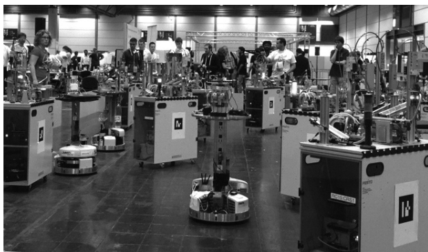
図1 ロジスティクスリーグの様子。 円形の移動台車が無人搬送車で直方体が工場内の工作機械に相当する
