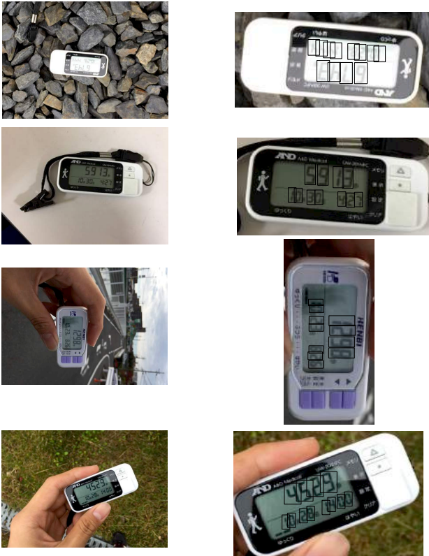
図 3: 左: 訓練に用いた歩数計画像 右: アノテーションされた歩数計画像
