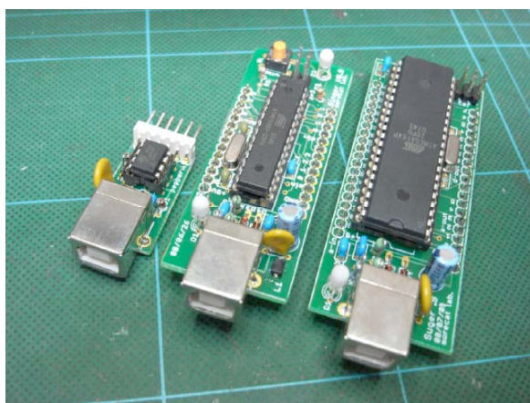
図3 USBをソフトウェアで実装したPCP用デバイス 左から、Pepper, Ginger, Sugar
